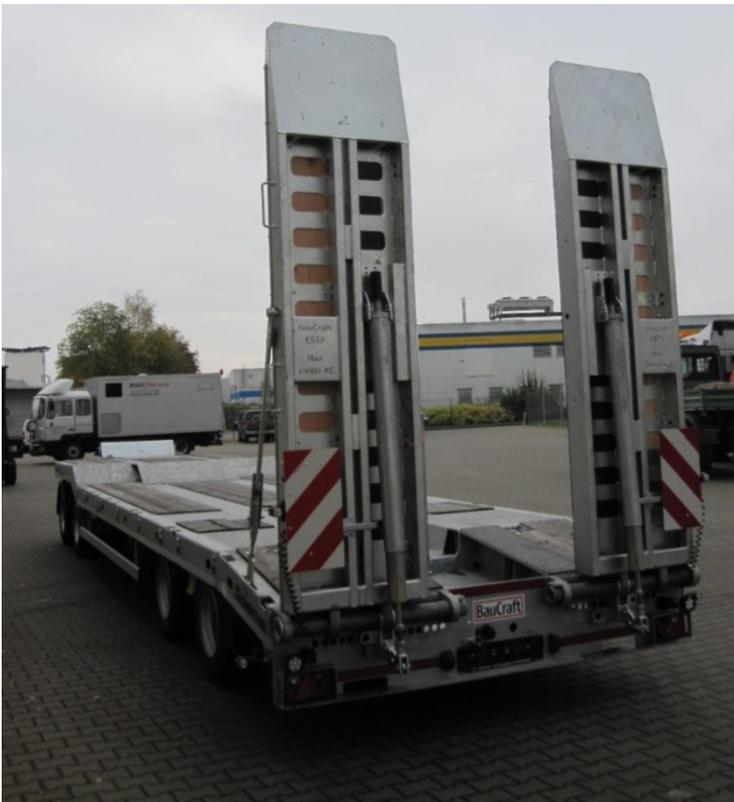
Die Rampen sind mit einer ausgesprochen stabilen Feststellstange mit mittig angeordnetem Spangengewinde gesichert. Diese Vorrichtung fällt bei anderen Fahrzeugen oft sehr dürftig und unpraktisch aus. Wir haben auch bei dieser Konstruktion darauf geachtet, dass das Arbeiten mit Handschuhen und Kälte keinerlei Handling Probleme bereitet.
