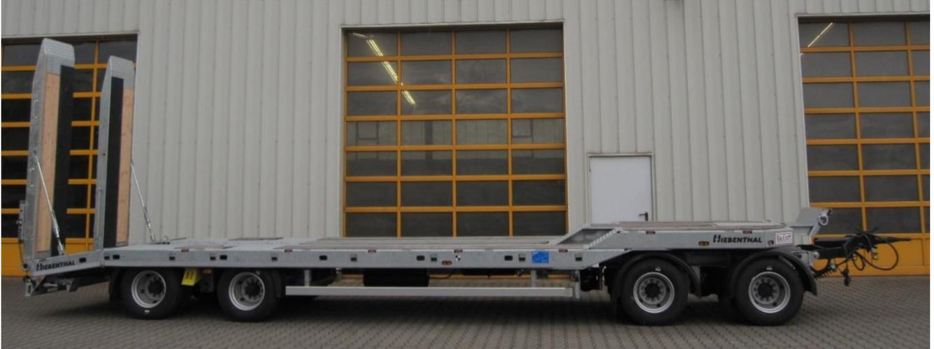
Hier sieht man die Seitenansicht unseres TAH 40 mit gekröpftem Plateau. Die Ladefläche ist ca. 9.500 mm lang und ermöglicht eine einfache Beladung hoher Arbeitsgeräte. Die Ladehöhe beträgt unbeladen ca. 900 mm, damit können problemlos Arbeitsgeräte mit einer Gesamthöhe von bis zu
