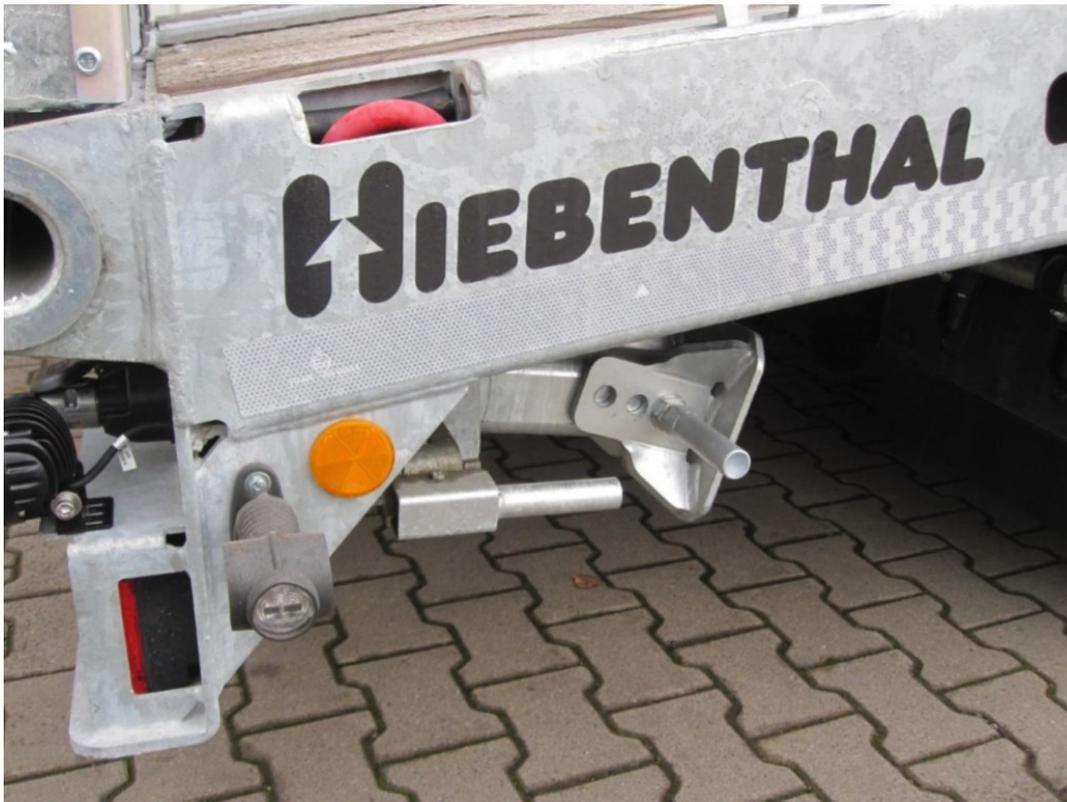
Fallstützen am Heck verhindern das Absenken des Hecks bei der Beladung. Durch die 3 m langen Rampen und die Möglichkeit das Heck um bis zu 60mm abzusenken (option) erreichen wir einen sehr niedrigen Böschungswinkel.
