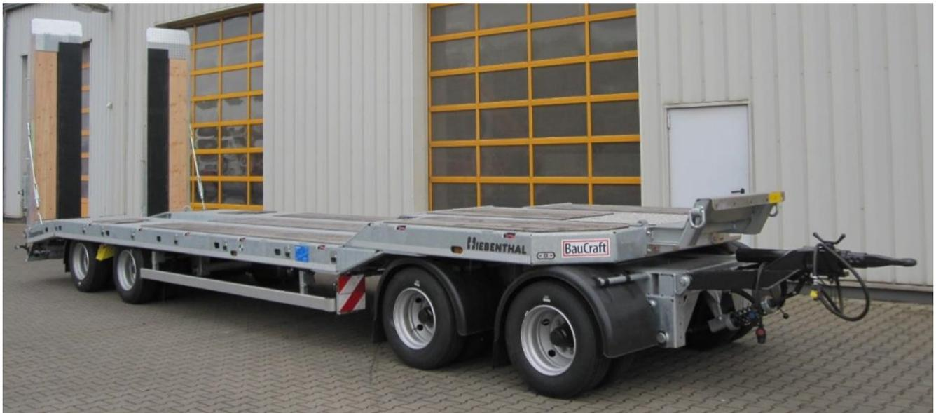
Die seitlichen Begrenzungsleuchten sind in dem Außenrahmen eingelassen und somit weitgehend vor Beschädigungen geschützt. Die Halterungen für die Unterlegkeile sind zwischen den Hinterachsen verbaut.
