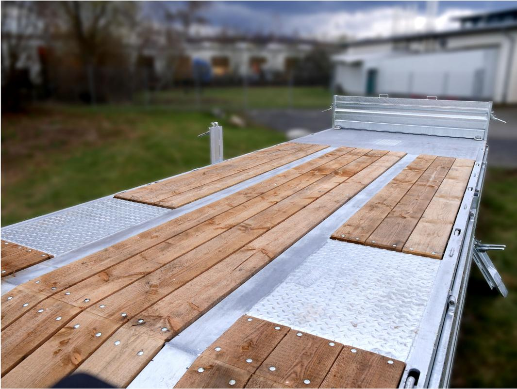
Ladefläche mit zahlreichen Zugrößen nach DIN EN12640 der UVV. Teile der Fahrzeugladeflächen besteht aus Lärche, einem sehr strapazierfähigen Nadelholz das durch den hohen Harz Anteil nicht verrottet, sondern mit der Zeit edel Silbergrau wird.
