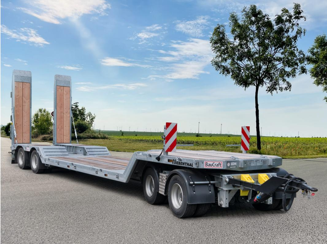
Hier sieht man die Seitenansicht des Fahrzeuges mit seiner tief abgesenkten Ladefläche. Das Tiefbett ist ca. 4.500 mm lang und ermöglicht eine einfache Beladung sehr hoher Arbeitsgeräte. Die Ladehöhe beträgt nur ca. 550 mm, damit können problemlos Arbeitsgeräte mit einer Gesamthöhe von bis zu ca. 3.450 mm transportiert werden.
