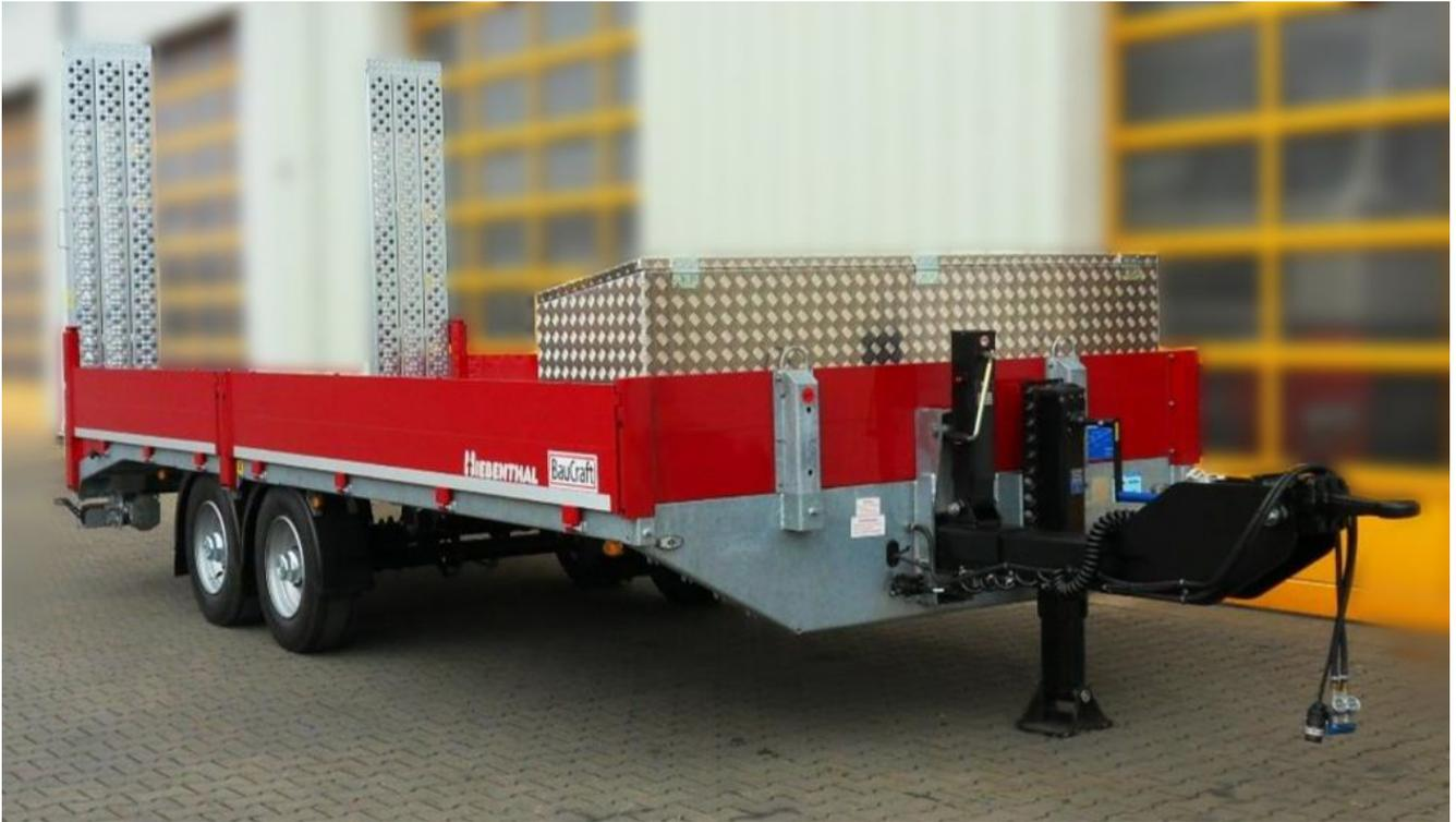
Die Abstützung des Fahrzeuges erfolgt über eine Getriebe Stützwinde. Zum Aufsteigen ist ein stabiler Auftritt am Stirnwall angeschweißt. Das Zugrohr ist mit einer Höhenverstellung ausgestattet. Über eine Kurbel kann die Zugöse stufenlos zwischen 700 - 1.000 mm eingestellt werden und sich damit Ihrem Fahrzeugpark anpassen.
