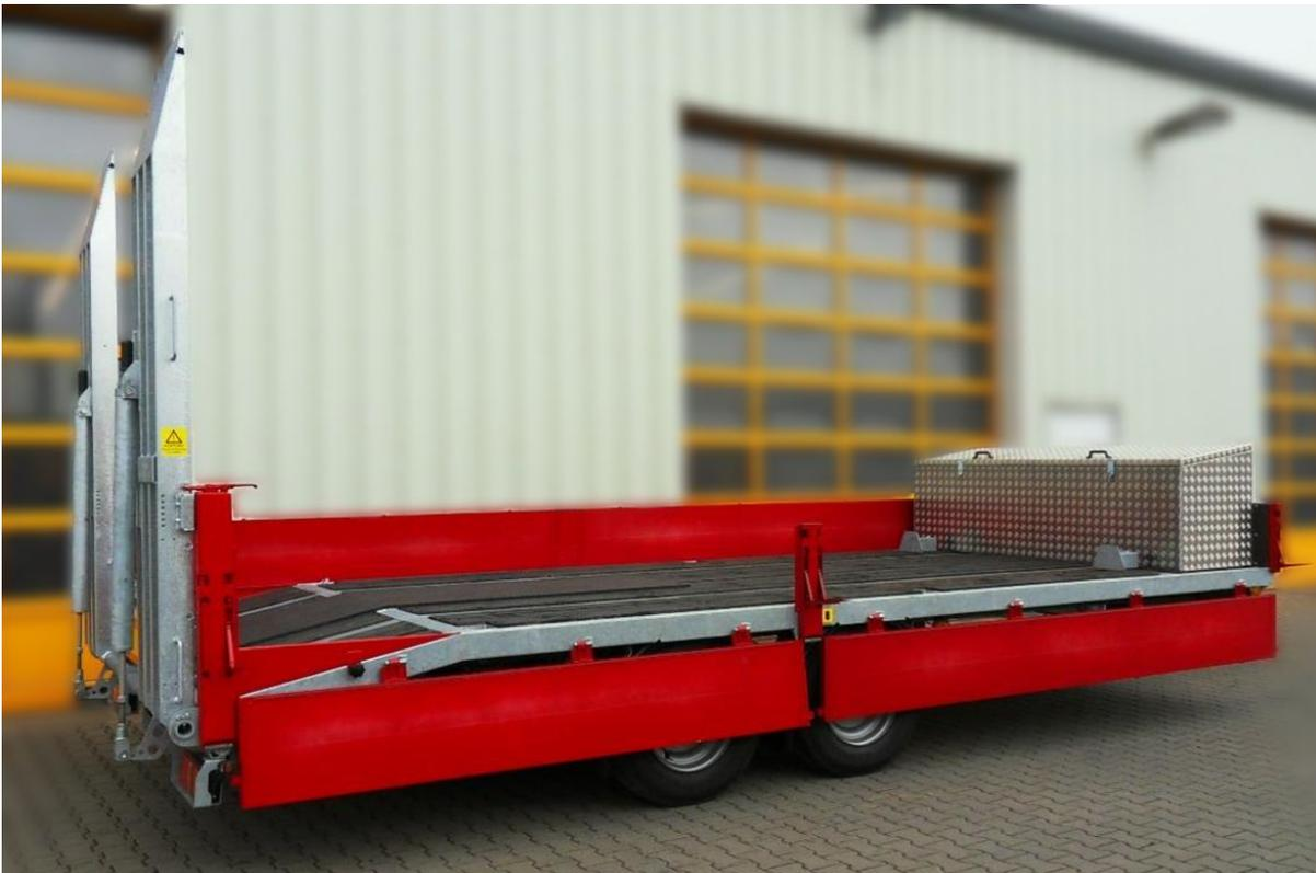
Das Fahrzeug ist trotz seiner Leichtbauweise robust und langlebig konstruiert. Mit seiner Bereifung 235/75 R 17,5 Reifen, den luftgefederten Markenachsen und der Trommelbremsen mit ABS lässt das Fahrverhalten keine Wünsche offen und das bei jedem Beladungszustand.
