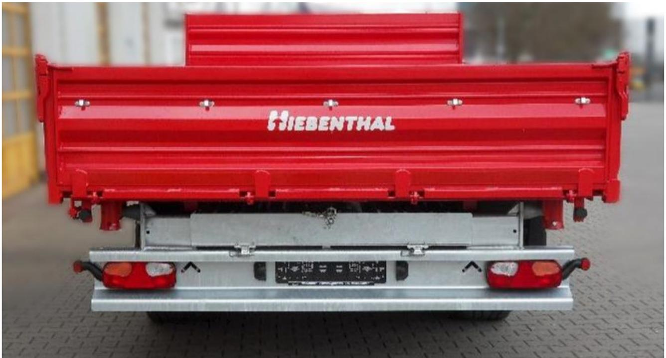
Das Fahrzeug ist am Heck mit einer Ablage für optionale Rampen ausgestattet.
