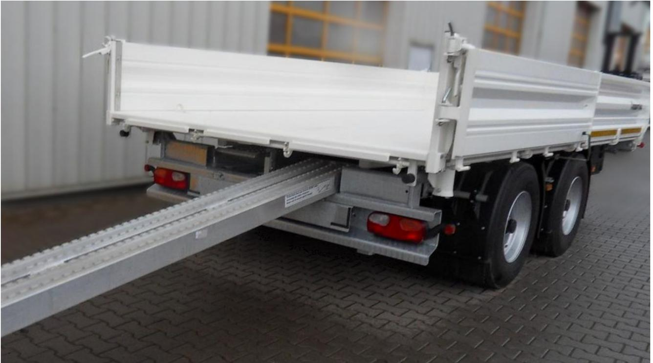
Im unteren Bild ist der Schacht zu sehen, in den die Schienen hineingeschoben werden. Der Aufbewahrungsschacht wird mit einer Klappe verschlossen. Die 7 Kammer Rückleuchten sind gut geschützt im Heckträger untergebracht.
