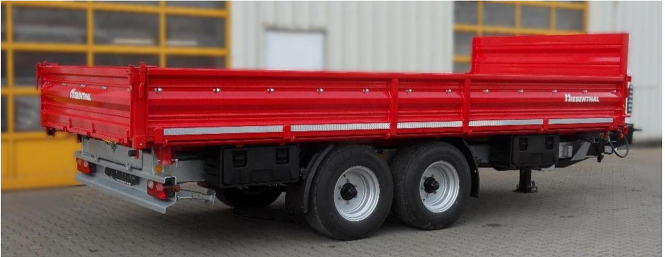
Unser TTK 11,9 hat eine Nutzlast von 8.410 Kg und kann 6,2 m<sup>3</sup> bei einer Bordwandhöhe von 500 mm laden. Markenachsen mit Parabelfederung und einer 4-fach Bereifung 235/75 R 17,5 in der Serienausstattung lassen keine Wünsche offen.
