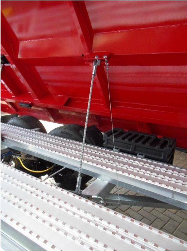
Der Kippwinkel wird über ein stark dimensionierte Stahlseil begrenzt, Im Bild sieht man zusätzlich noch die eingelegten Rampen (optional) und den Werkzeugkoffer.
