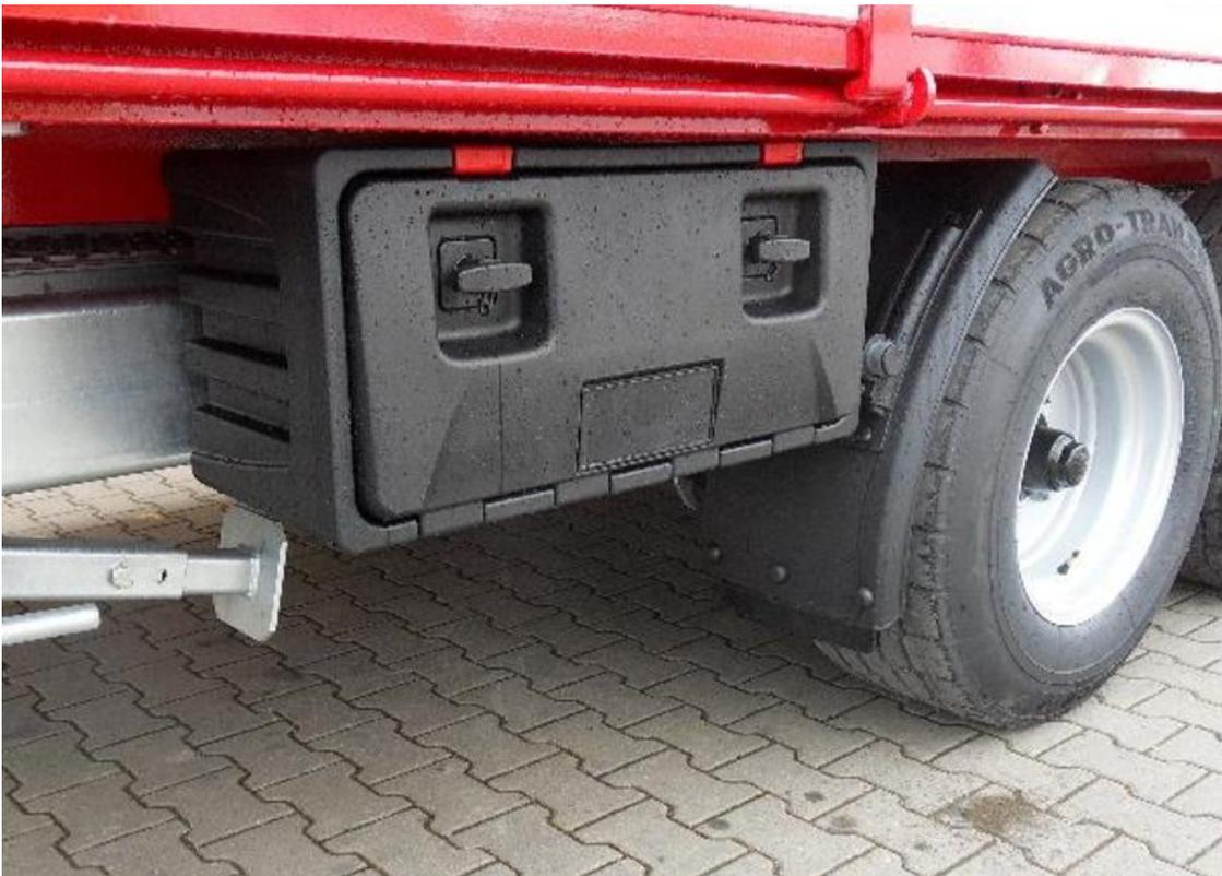
Der Werkzeugkoffer wird über stabile Stahlwinkel an den Fahrzeugrahmen geschraubt und hält so den praxisgerechten Strapazen locker stand.
