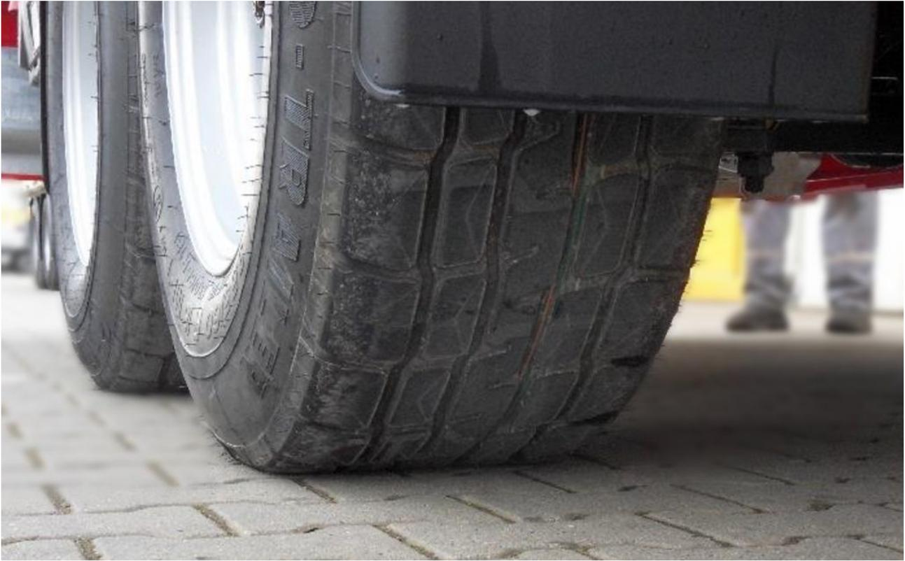
Dieses Fahrzeug wurde mit Breitreifen 355/60 R18 (Option) ausgerüstet und ist daher auch für losen Untergrund geeignet.
