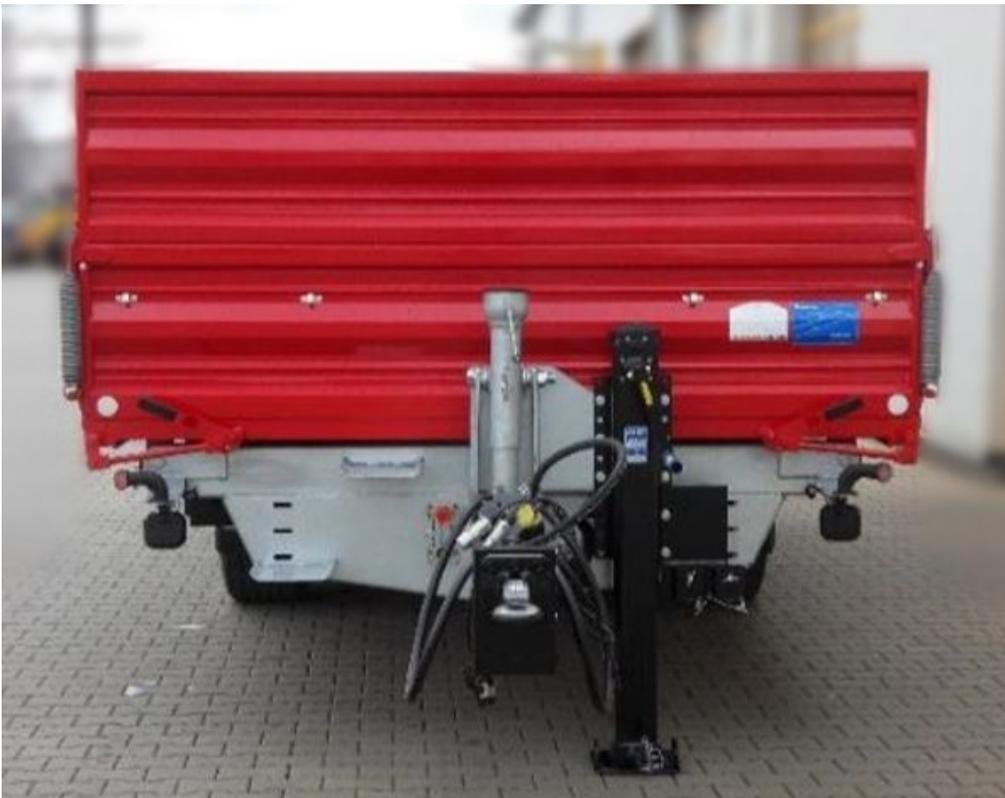
Das höhenverstellbare Zugrohr ist mit einer 40er DIN Zugöse ausgestattet und wird über eine robuste Winde abgestützt.
