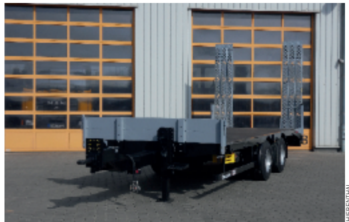
18 t-Tandem-Tieflader mit abgenommenen Bordwänden und Lochblechprägerampen.
